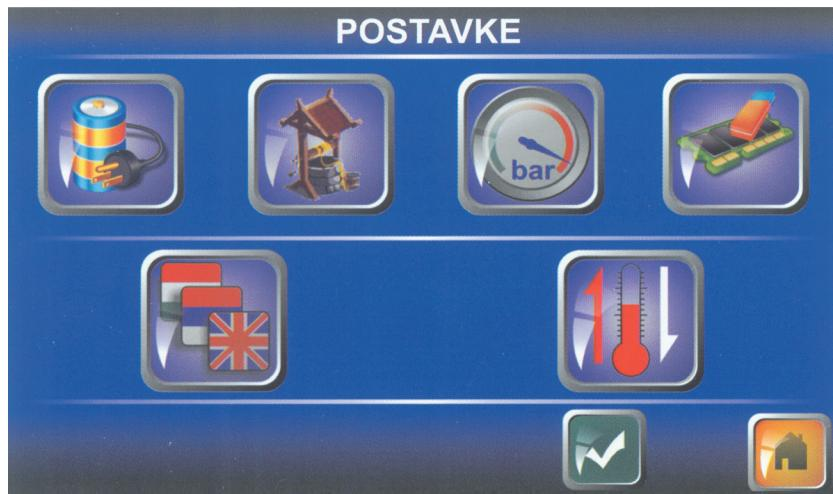
Izgled displeja za izbor parametara koji se žele podešavati. Parametri su logički razvrstani. Kontroler je zaštićen od unosa parametara koji mogu poremetiti ispravan rad uređaja.
