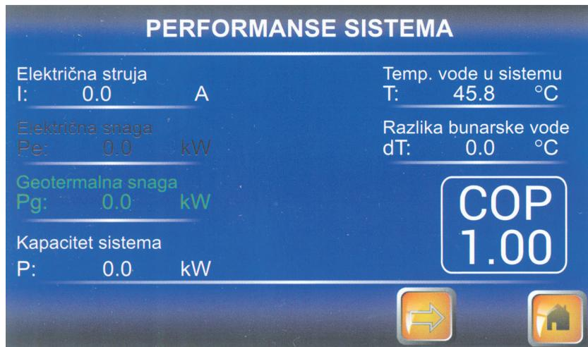
Korisnik na ovom displeju može kontinualno pratiti potrošnju (trenutnu električnu snagu ) toplotne pumpe, geotermalnu snagu, ukupnu snagu toplotne pumpe, temperaturu vode u sistemu, razliku temperature bunarske vode ili trenutni koeficijent grejanja (COP).
